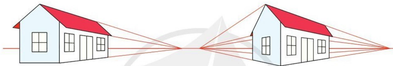
Hình 12.7. Phối cảnh một điểm tụ và phối cảnh hai điểm tụ của một ngôi nhà
