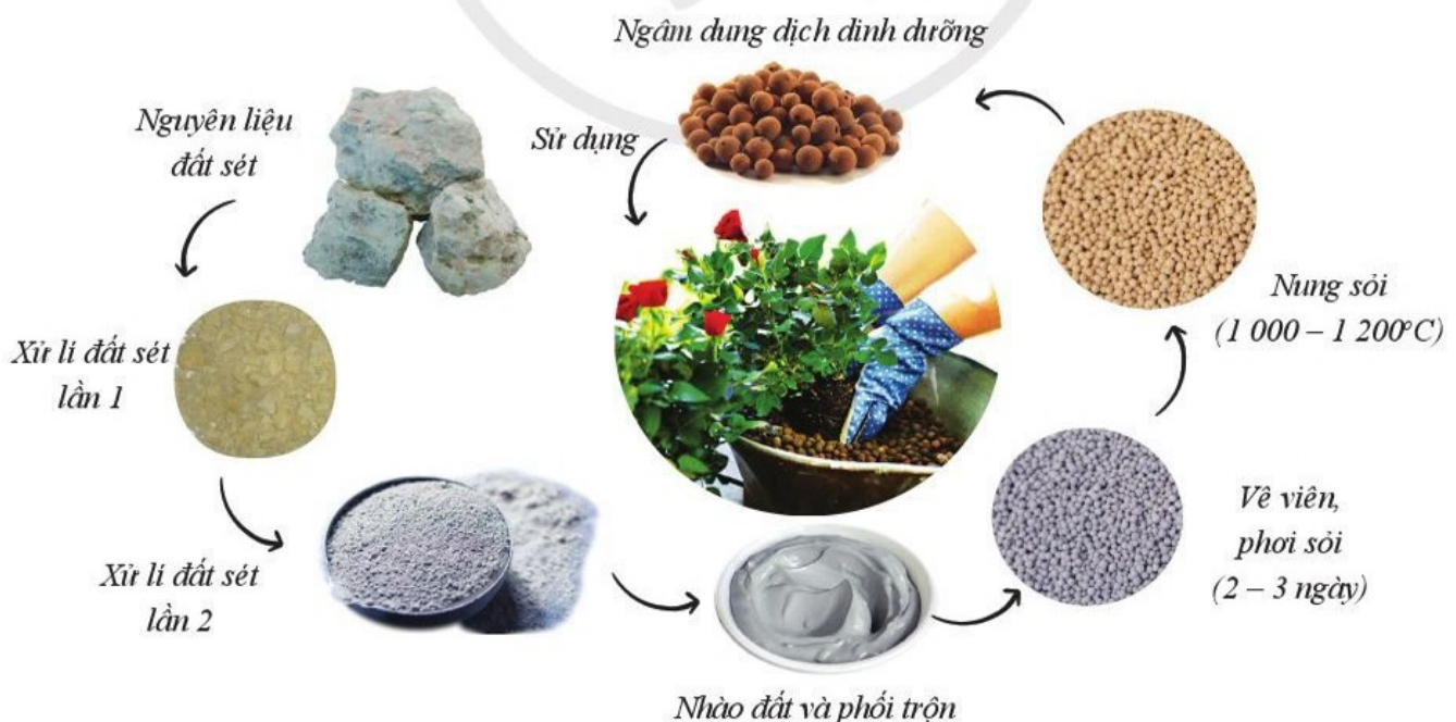
Hình 6.5. Quy trình sản xuất sỏi nhẹ keramzit
