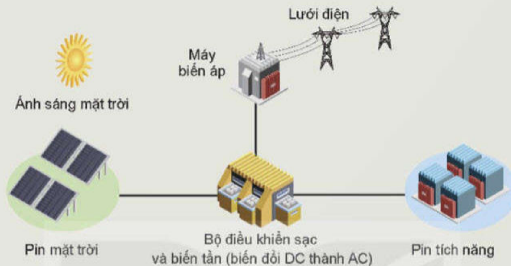
Hình 5.7. Các thành phần chính của nhà máy điện mặt trời
