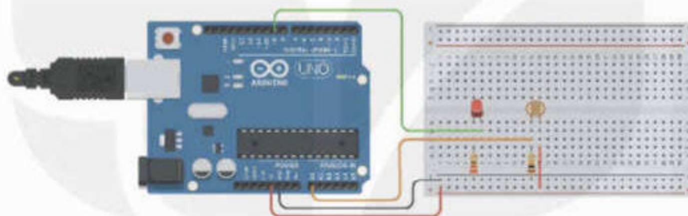
Hình 26.2. Mạch điện tự động điều chỉnh cường độ sáng của LED theo điều kiện chiếu sáng xung quanh
