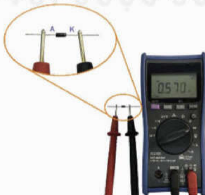
Hình 16.9. Kiểm tra diode
