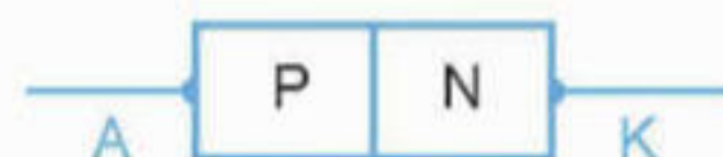
Hình 16.3. Cấu tạo của diode
