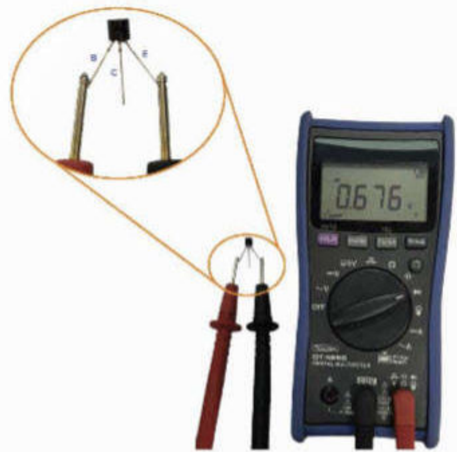
Hình 16.10. Kiểm tra transistor
