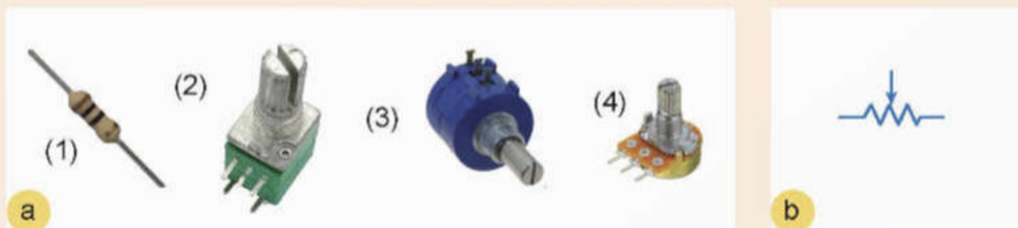
Hình 15.5. a) Hình dạng một số loại điện trở b) Kí hiệu biến trở
