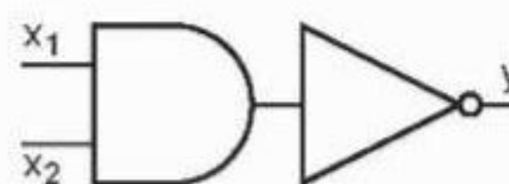
Hình 21.16. Cấu tạo cổng NAND từ AND và NOT
