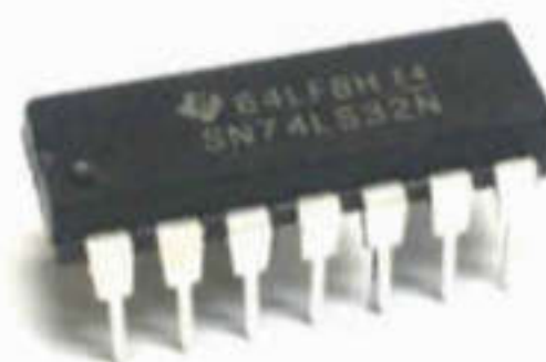
Hình 21.7. Sơ đồ chân và IC tích hợp 4 cổng OR (IC 74LS32)
