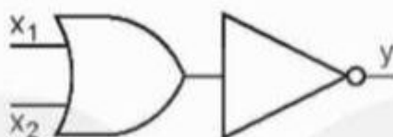
Hình 21.13. Cấu tạo cổng NOR từ OR và NOT
