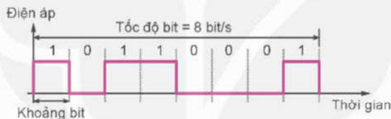
Hình 21.4. Tốc độ bit và khoảng bit
