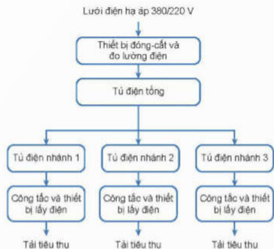
Hình 8.2. Sơ đồ cấu trúc chung của hệ thống điện trong gia đình
