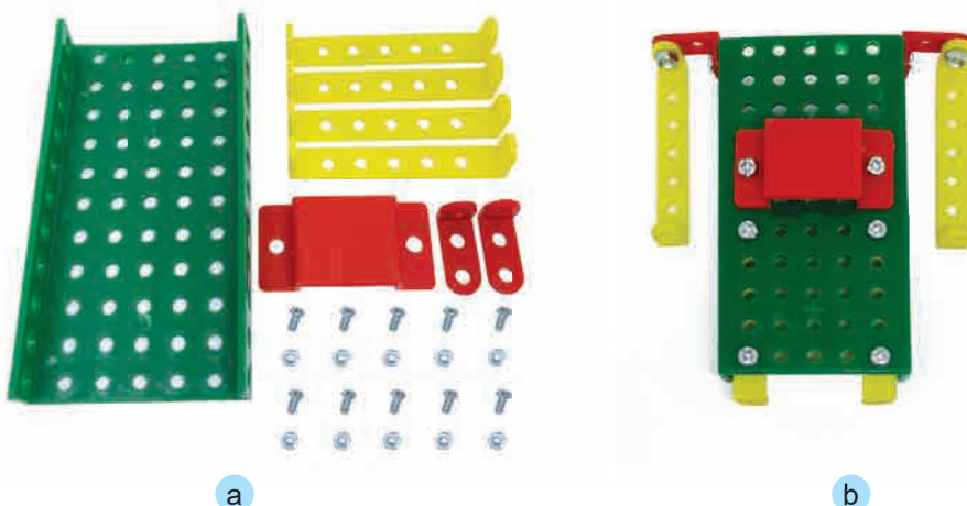
Hình 3 Các chi tiết và thân robot
