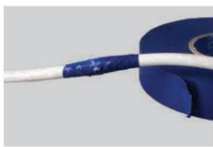
d) Kiểm tra, bọc kín chỗ cách điện bị hỏng trên vỏ dây dẫn
