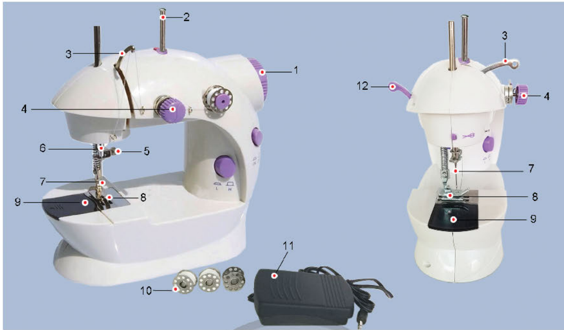
Hình 3.3. Các bộ phận chính của máy may chạy điện: 1) Trục quay kim; 2) Trục giữ chỉ; 3) Cò giật chỉ; 4) Ốc điều chỉnh sức căng của chỉ; 5) Ốc vận kim; 6) Trụ kim; 7) Kim máy; 8) Chân vịt; 9) Khoang suốt; 10) Suốt chỉ; 11) Bàn đạp; 12) Cần gạt chân vịt
