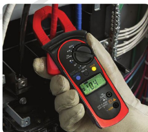
Hình 2.8. Đo cường độ dòng điện bằng ampe kẹp
