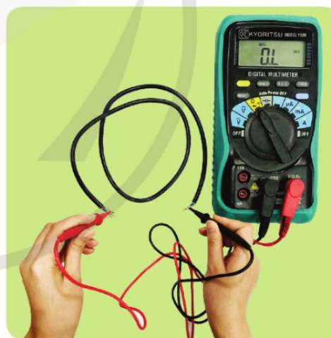
Hình 2.6. Đo thông mạch dây dẫn điện bằng đồng hồ vạn năng
