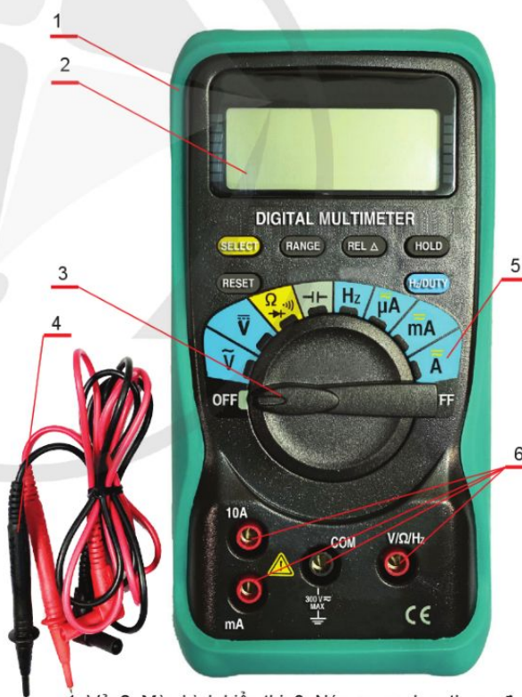
1. Vỏ; 2. Màn hình hiển thị; 3. Núm xoay chọn thang đo; 4. Que đo; 5. Thang đo; 6. Giắc cắm que đo
