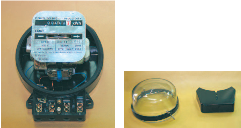
Hình 4 - 1. Công tơ điện.
