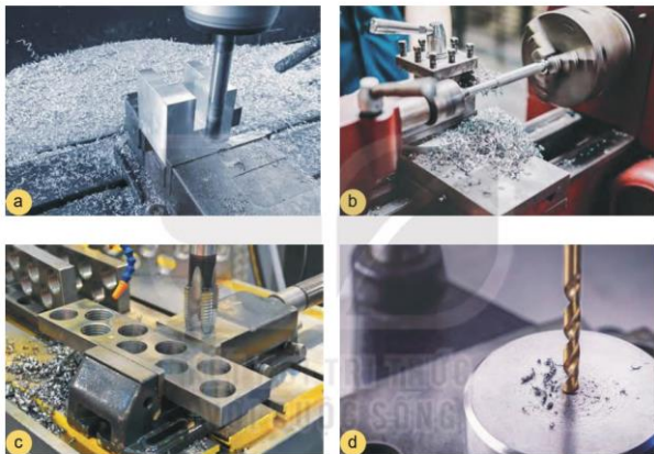
Hình 7.4. Một số phương pháp gia công cơ khí có phoi
