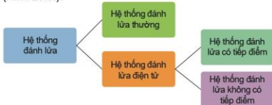
Hình 20.9. Sơ đồ phân loại hệ thống đánh lửa
