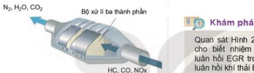
Hình 20.12. Cấu tạo của bộ xử lí ba thành phần
