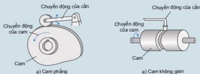
Hình 12.4. Một số nguyên lý cơ cấu cam
