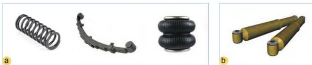
Hình 23.7. Bộ phận đàn hồi (a) và bộ phận giảm chấn (b)
