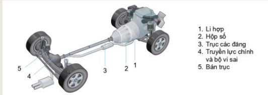
Hình 22.2. Hệ thống truyền lực ô tô
