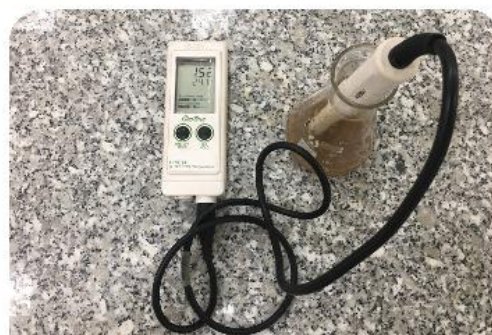
Hình 6.5. Đo pH bằng máy đo pH
