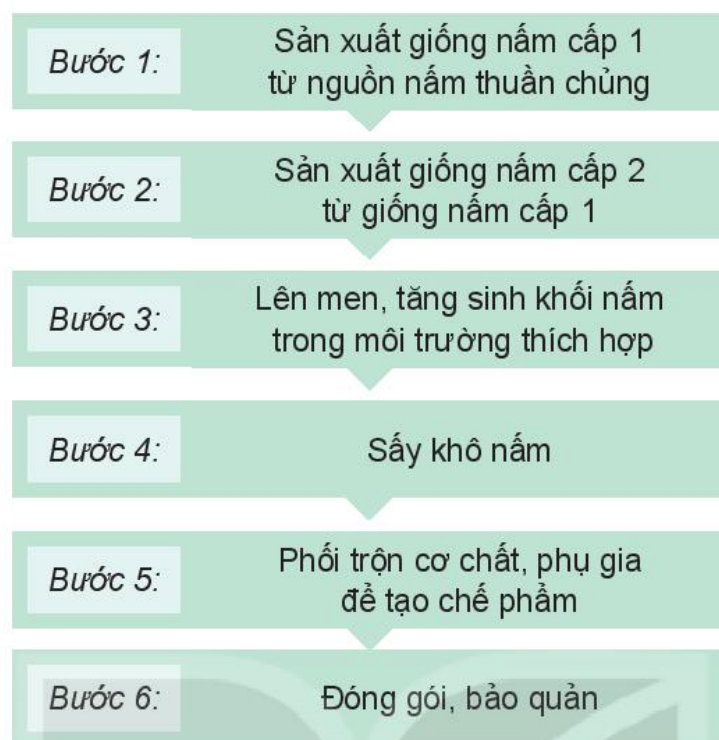
Hình 18.5. Các bước sản xuất chế phẩm nấm trừ sâu, bệnh
