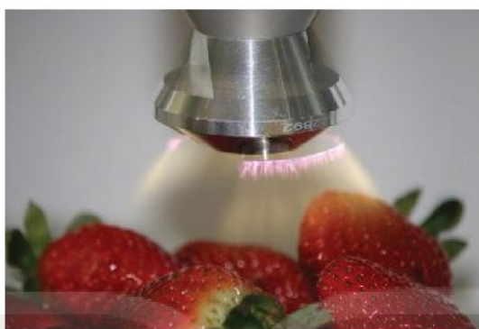
Hình 20.8. Xử lý quả dâu tây bằng công nghệ plasma lạnh
