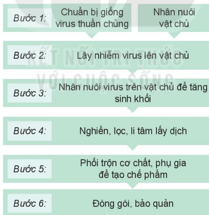
Hình 18.3. Các bước sản xuất chế phẩm virus trừ sâu
