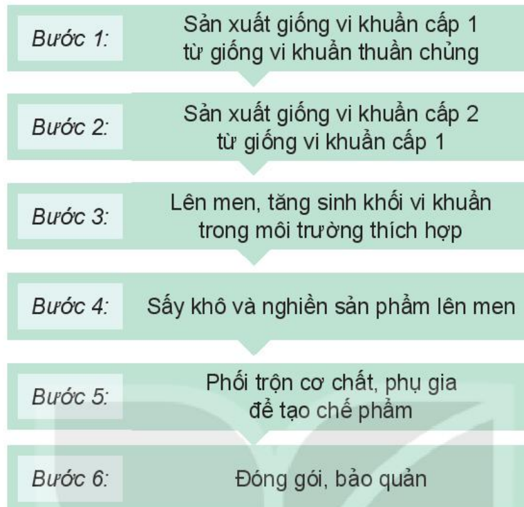
Hình 18.1. Các bước sản xuất chế phẩm vi khuẩn trừ sâu
