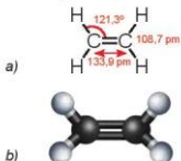
Hình 16.2. Công thức cấu tạo (a) và mô hình phân tử (b) của ethylene
