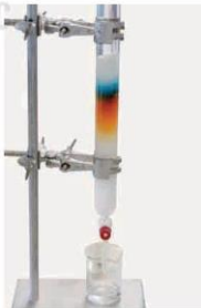
Hình 11.8. Thiết bị, dụng cụ thực hiện tách chất bằng phương pháp sắc kí cột
