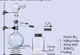
Hình 16.6. Điều chế acetylene và thử tính chất
