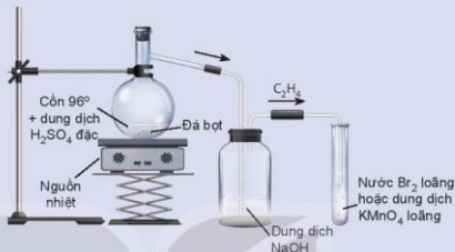
Hình 16.5. Điều chế ethylene và thử tính chất
