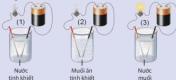
Hình 2.2. Thử tính dẫn điện của dung dịch muối ăn
