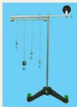
Hình 6.3. Thí nghiệm về dao động cưỡng bức
