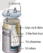
Hình 21.5. Cấu tạo của tụ điện hình trụ
