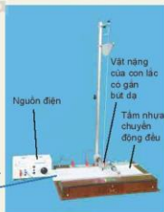
b) Bộ thí nghiệm khảo sát dao động tắt dần của con lắc đơn
