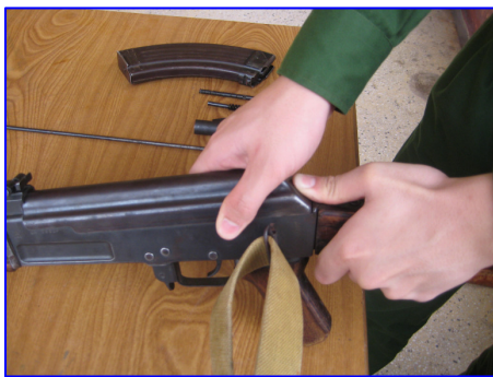
Hình 4-24. Tháo nắp hộp khoá nòng.
