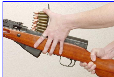
Hình 4-46. Lắp kẹp đạn vào súng
