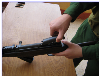
Hình 4-49. Tháo nắp hộp khoá nòng
