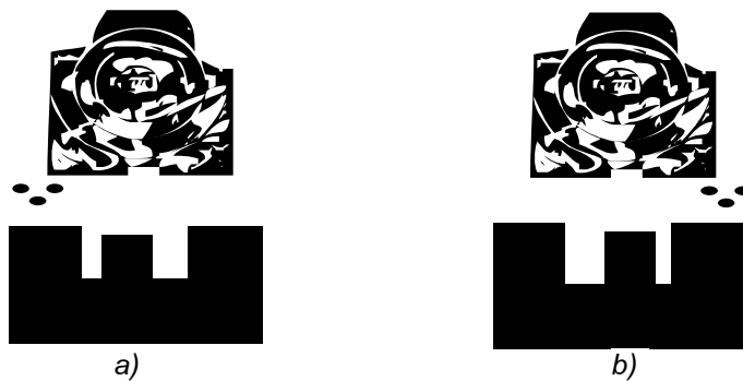
Hình 5-7. Chính giữa mép trên đầu ngắm vừa thấp vừa lệch trái (a) ; vừa thấp vừa lệch phải (b) so với điểm chính giữa mép trên khe ngắm.
