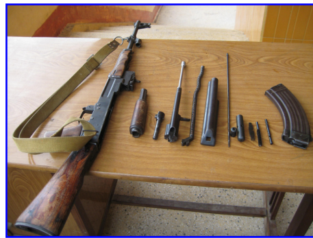
Hình 4-28. Thứ tự các bộ phận khi tháo xong (từ phải qua trái).
