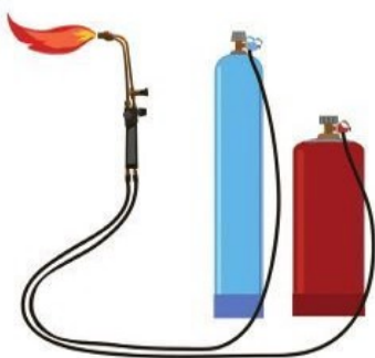
Hình 15.1. Đèn xì acetylene dùng để hàn, cắt kim loại
