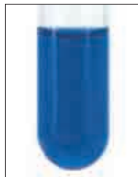
Hình 7.15. \text{Cu}(\text{OH})_2 tan trong dung dịch \text{NH}_3 tạo ra [\text{Cu}(\text{NH}_3)_4]^{2+} màu xanh lam
