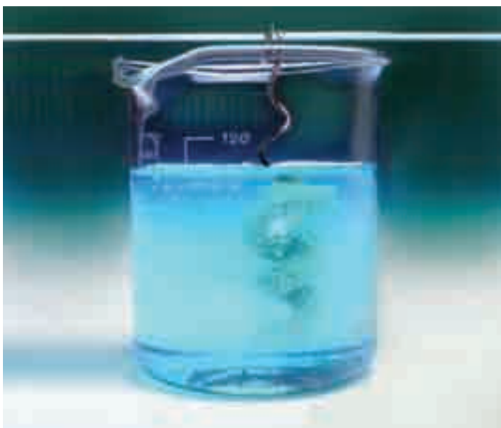
Thí nghiệm Cu khử ion \text{Ag}^+ trong dung dịch \text{AgNO}_3
