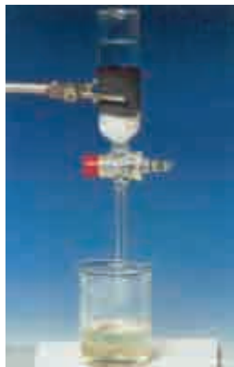
Hình 5.2. Fe tác dụng với dung dịch \text{CuSO}_4
