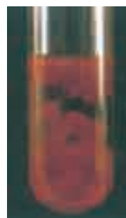
Hình 7.5. Kết tủa \text{Fe}(\text{OH})_3
