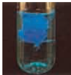
Hình 7.14. Kết tủa \text{Cu}(\text{OH})_2
