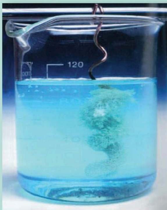
Thí nghiệm Cu khử ion Ag^+ trong dung dịch AgNO_3
