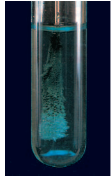
Hình 1.20. Cu tác dụng với dung dịch \text{AgNO}_3
