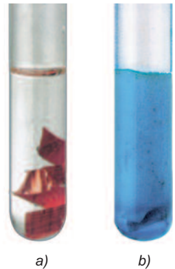
Hình 1.10. a) \text{H}_2\text{SO}_4 loãng không tác dụng với Cu b) \text{H}_2\text{SO}_4 đặc tác dụng với Cu
