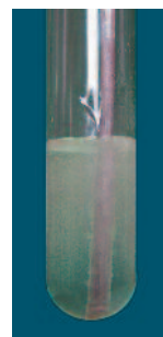
Hình 2.11. Nhôm phản ứng với dung dịch HCl
