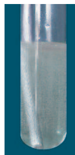
Hình 2.13. Nhôm phản ứng với dung dịch NaOH
