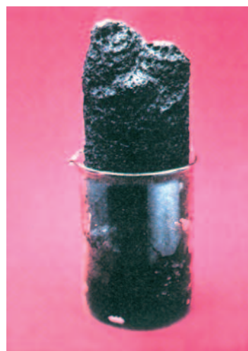
Hình 1.11. H_2SO_4 đặc tác dụng với đường
