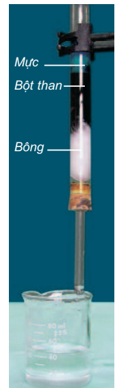
Hình 3.7. Thí nghiệm về sự hấp phụ màu của than gỗ
