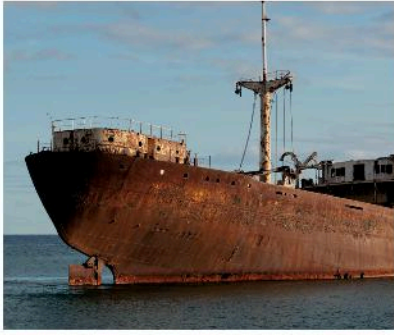
▲ Hình 11.4. Vỏ tàu biển bị ăn mòn
