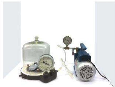
▲ Thí nghiệm với chuông điện trong bình đã hút hết không khí
