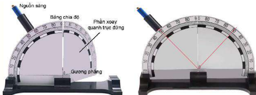
▲ Hình 16.3. a) Bố trí thí nghiệm; b) Quan sát tia sáng tới và tia sáng phản xạ khi nửa bên phải của bảng chia độ cùng mặt phẳng với nửa bên trái
