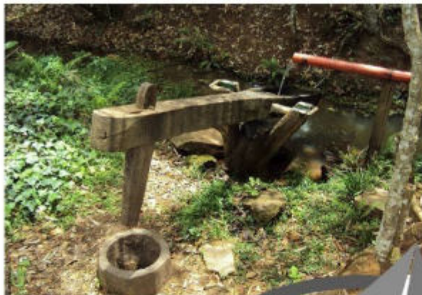
Hình 19.9. Chày giã gạo bằng sức nước.
