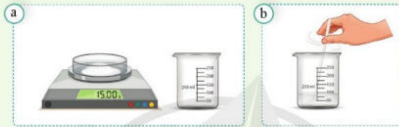
Hình 6.2. Thí nghiệm pha chế dung dịch đường ăn 15%
