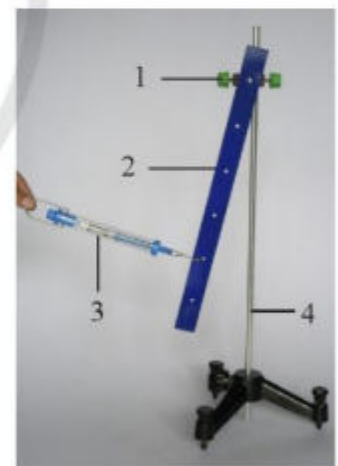
Hình 18.2. Kéo lực kế để thanh nhựa quay
