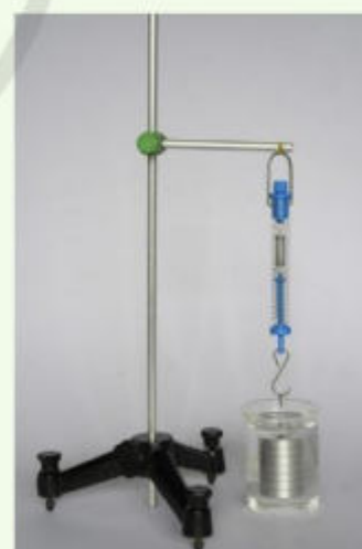
b) Lực kế chỉ trọng lượng của khối nhôm chìm trong nước
