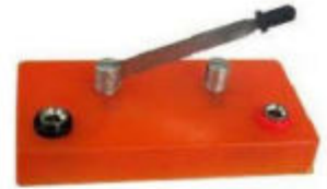
Hình 16. Công tắc đơn giản
