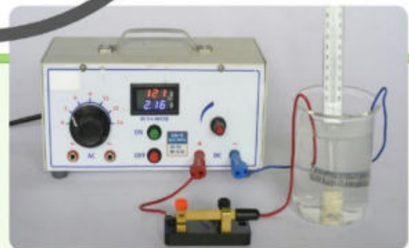
Hình 22.4. Bộ trí dụng cụ thí nghiệm tìm hiểu tác dụng nhiệt của dòng điện
