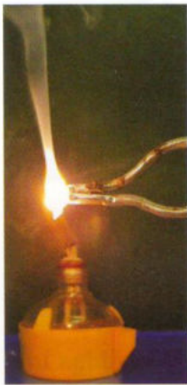
▲ Hình 2.5. Thí nghiệm đốt cháy mảnh magnesium
