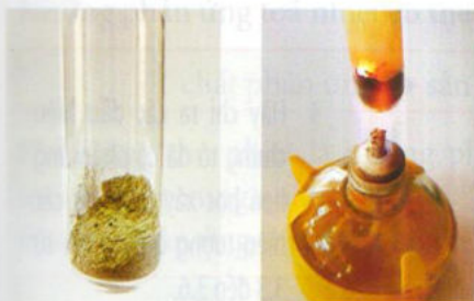
▲ Hình 3.1. a) Hỗn hợp bột sắt với lưu huỳnh trước khi đun; b) Chất rắn sau khi đun
