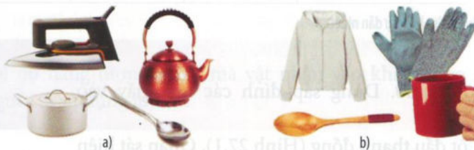
▲ Hình 27.2. Một số vật: a) dẫn nhiệt tốt; b) cách nhiệt tốt
