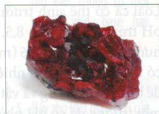
▲ Đá ruby với dải màu hồng đậm chứa các thành phần oxide của aluminium, chromium, ...
