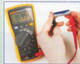
▲ Đo hiệu điện thế giữa hai cực của pin bằng đồng hồ đo điện đa năng
