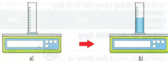
▲ Hình 15.3. a) Đo khối lượng m_d của ống đong; b) Đo khối lượng m của chất lỏng và ống đong
