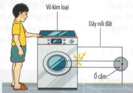
▲ Nối đất bảo vệ thiết bị điện và giữ an toàn cho người sử dụng
