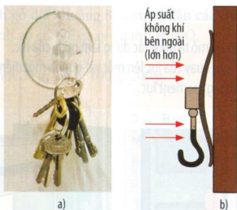
▲ Hình 18.3. a) Giác mút dùng làm móc treo vật; b) Giác mút bám chặt vào tường
