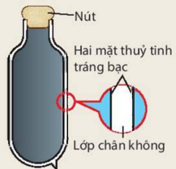
Hình 28.6 Cấu tạo ruột phích (bình thủy)
