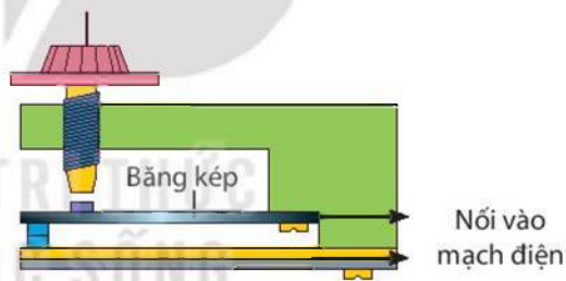
b) Băng kép đóng ngắt mạch điện
