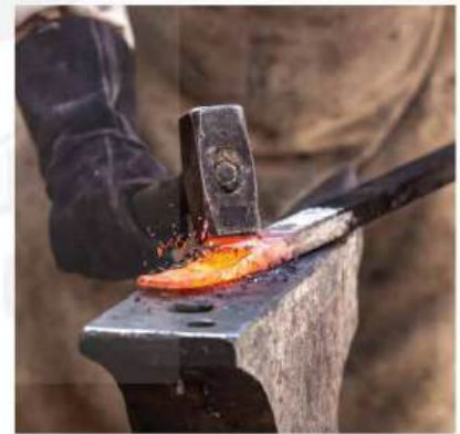
Hình 2.1 Búa chuyển động đập vào thanh thép, làm biến dạng thanh thép
