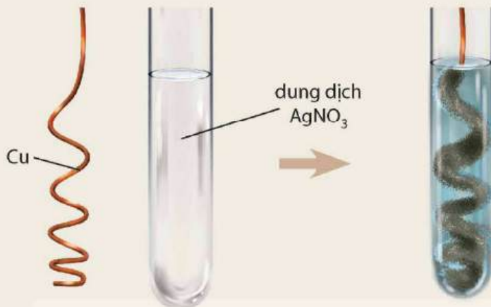
Hình 19.2 Phản ứng của kim loại Cu với dung dịch \text{AgNO}_3
