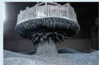
Hình 15.5 Ứng dụng của dòng điện xoay chiều tạo nam châm điện
