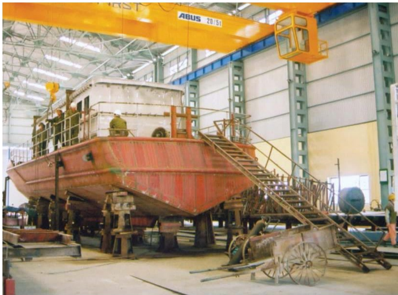
Hình 10. Xưởng sửa chữa tàu thuyền
