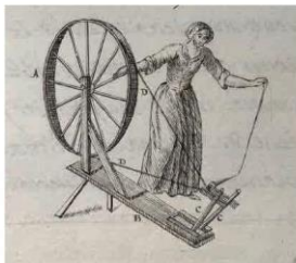
2.1 Kéo sợi bằng tay dùng 1 cọc suốt
