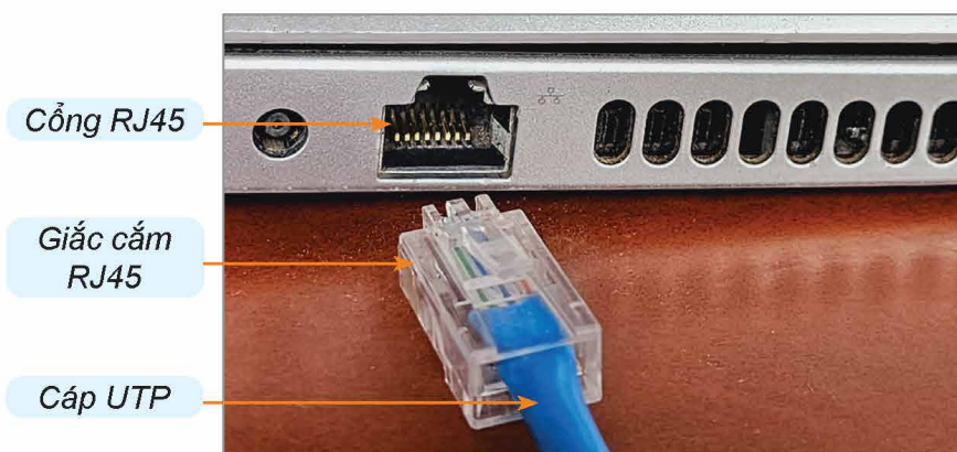
Hình 3.8. Giắc cắm và cổng RJ45
