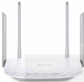
Hình 22.6. Một bộ thu phát Wi-Fi băng tần kép, 4 anten, hỗ trợ tối đa 25 người
