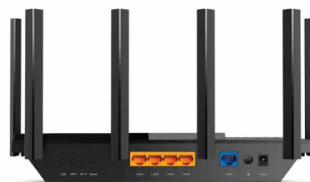
Hình 3.5. Một router Wi-Fi 6 anten có 1 cổng WAN và 4 cổng LAN
