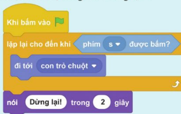
Hình 2. Chương trình điều khiển nhân vật chuyển động theo chuột máy tính
