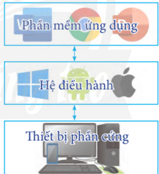
Hình 6. Phần mềm ứng dụng tương tác với thiết bị phần cứng thông qua hệ điều hành
