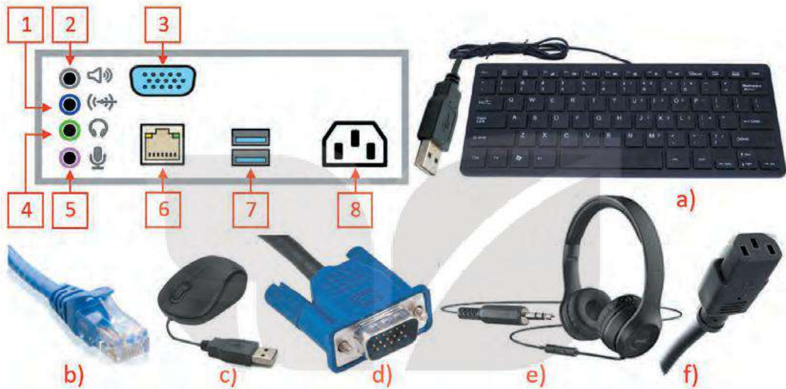
Hình 1.5. Cổng kết nối của máy tính và các đầu nối thiết bị
