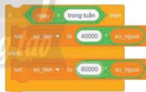
Hình 3. Sử dụng khối lệnh if – then – else để tính tiền vé xem phim
