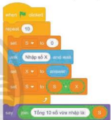
Hình 7. Chương trình nhập và tính tổng 10 số được nhập từ bàn phím
