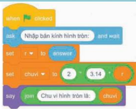
Hình 1. Chương trình tính chu vi hình tròn viết bằng ngôn ngữ Scratch
