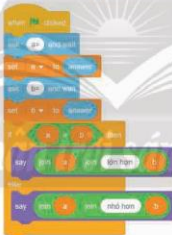
Hình 2. Chương trình đưa ra kết quả sai khi giá trị a, b bằng nhau
