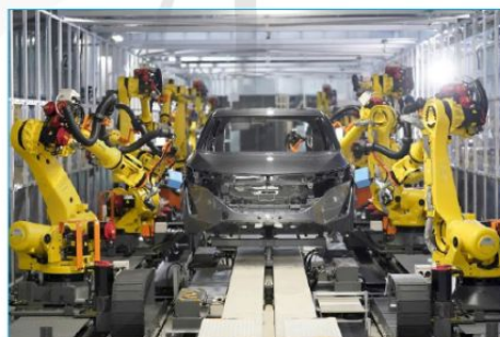
Hình 1. Dây chuyền lắp ráp tự động sử dụng robot
