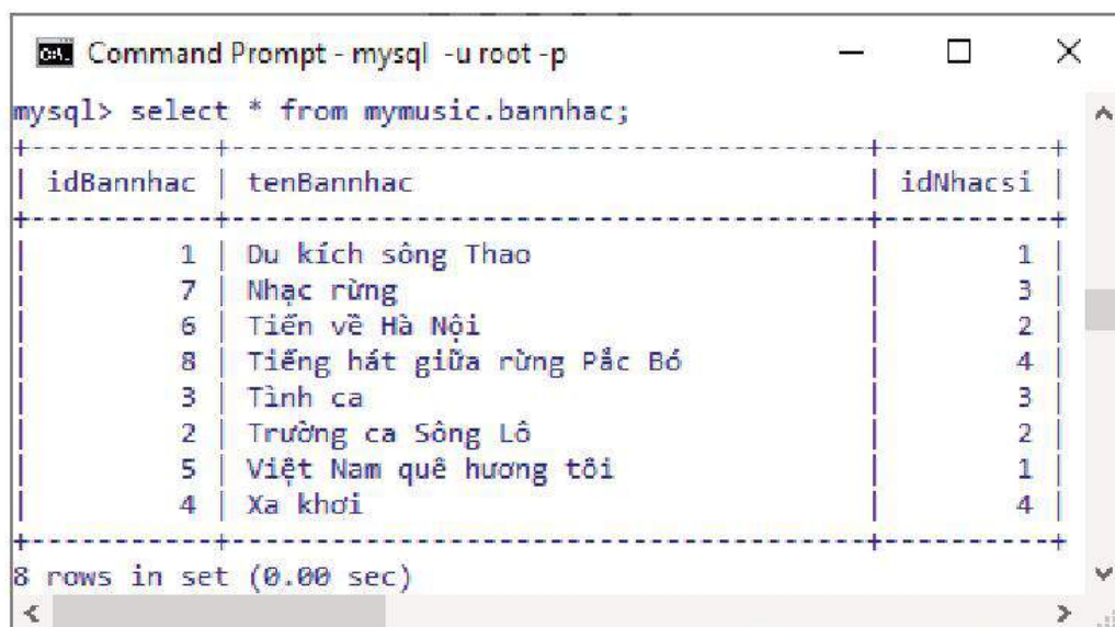
Hình 17.3. Ví dụ về câu truy vấn đọc toàn bộ nội dung bảng bannhac trong CSDL mymusic
