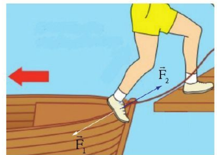
Hình 3.2. Chân tác dụng lực F_1 lên thuyền thì thuyền cũng tác dụng lực F_2 lên chân.
