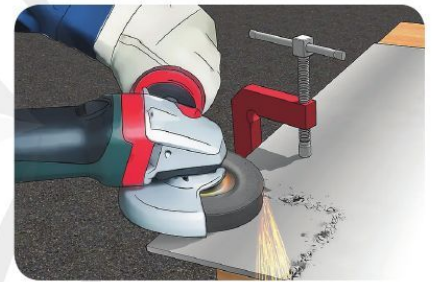
Hình 1.4. Các mảnh vụn sắt văng ra theo phương tiếp tuyến.
