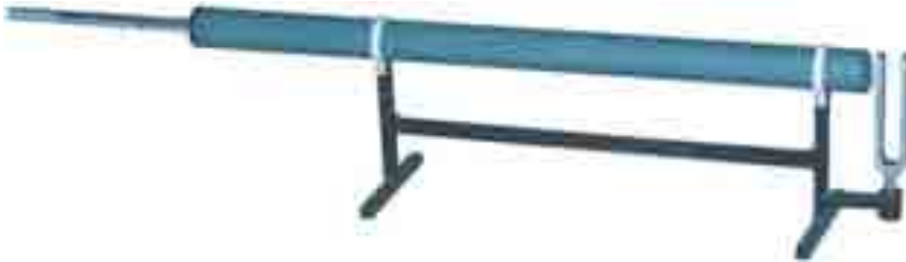
Hình 20.2 Dụng cụ xác định tốc độ truyền âm phát ra từ âm thoa.
