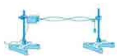
Hình 15.5 Hình dạng sóng dừng trên dây mà mắt nhìn thấy khi f > 24 Hz.
