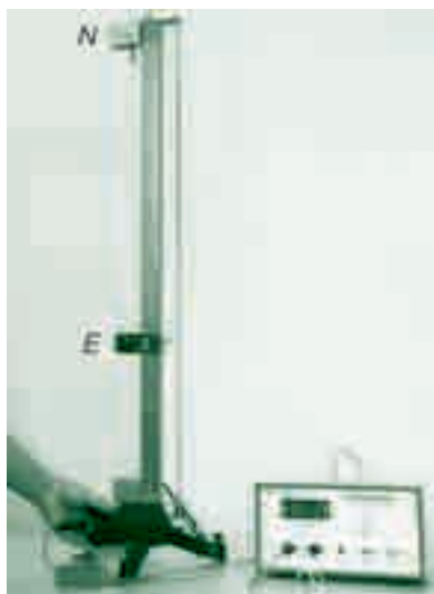
Hình 8.1. Bộ thí nghiệm đo gia tốc rơi tự do.
